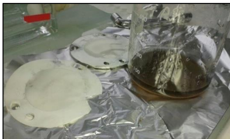
Photographie 2 : Récupération de la phase POCIS et dispositif d'élution
