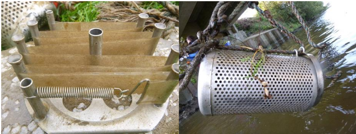
Photographie 4 : Système de fixation des SPMD et système d'accrochage des cages
