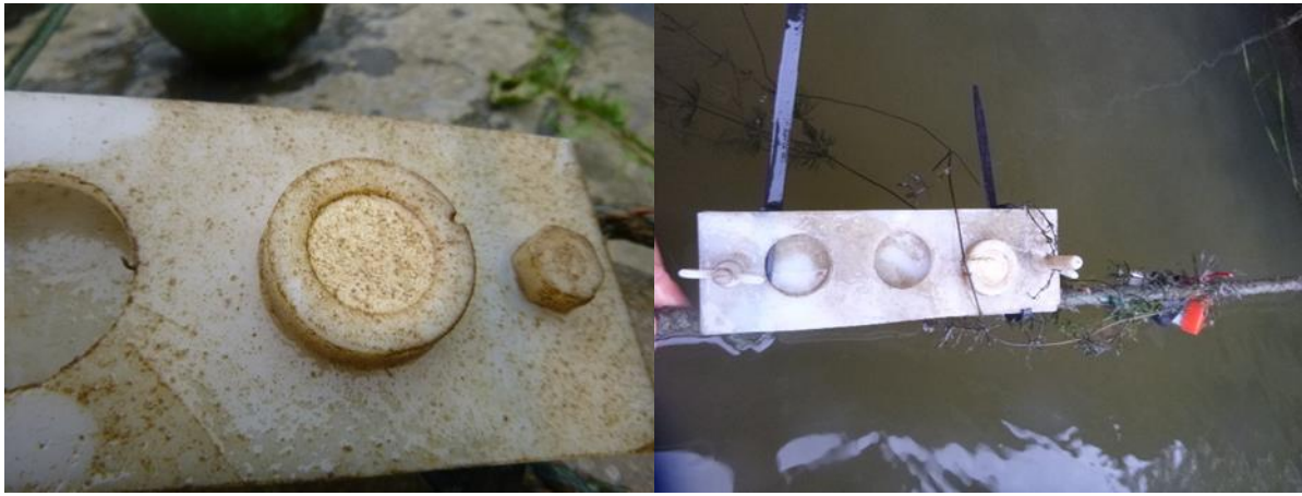
Photographie 3 : Système de fixation des DGT
