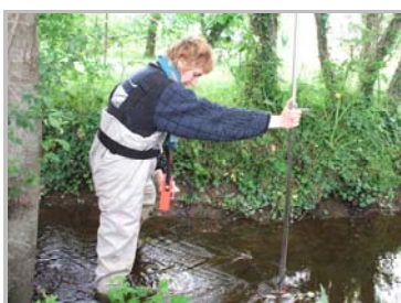
Figure 16 : Mesure de débit manuel à l'aide d'un moulinet sur les Hardes (havre de la Vanlée)
