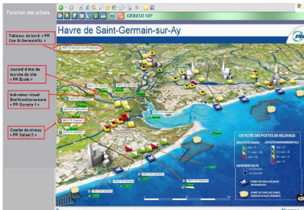
Figure 83 : Visualisation du synoptique en temps réel de l'état de fonctionnement des postes de relevage du havre de Saint-Germain-sur-Ay (Ecran du poste de télégestion)
