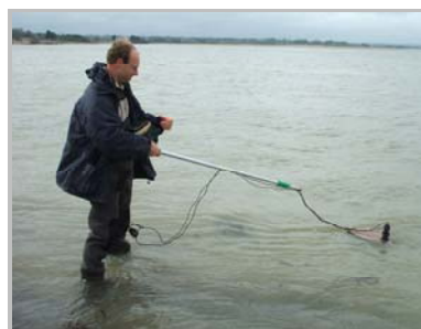
Figure 15 : Mesure de vitesses et profondeurs à l'aide d'un speedo-sondeur (havre de la Vanlée)
