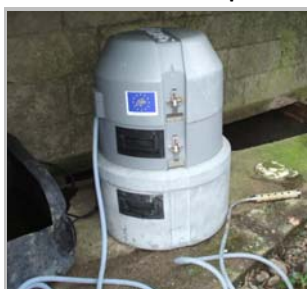
Figure 12 : Préleveur automatique implanté sur le Boscq
