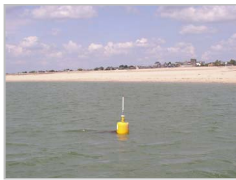
Figure 37 : Bouée de type Smatch en phase de mesure
