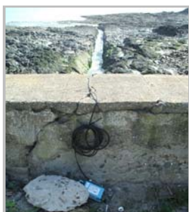
Figure 14 : Sonde de niveau (débitmètre) implantée sur le Boscq
