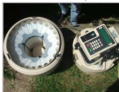
Figure 13 : Détail d'un préleveur automatique
