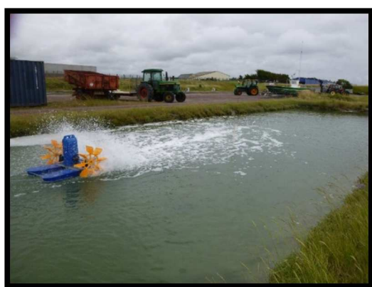
Figure 17 : Bassin expérimental oxygéné grâce à un aérateur à palettes
