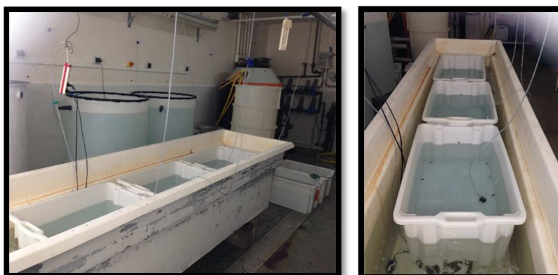
Figure 13 : Structure d'élevage pour l'expérimentation de l'effet de la température (21°C) sur la croissance de Sepia officinalis
