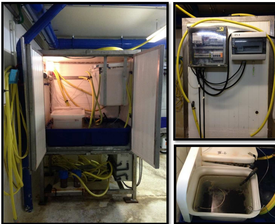
Figure 8 : Equipement thermo-régulé de conditionnement (ETC) utilisé pour l'incubation des œufs de Sepia officinalis
