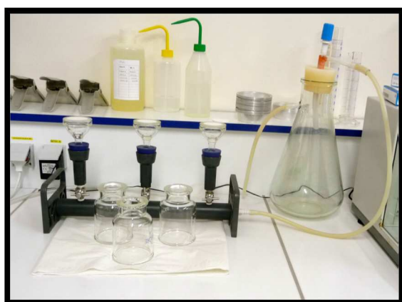
Figure 19 : Matériels utilisés pour la filtration (à gauche) et l'analyse de la chlorophylle a (à droite) pour quantifier la biomasse phytoplanctonique
