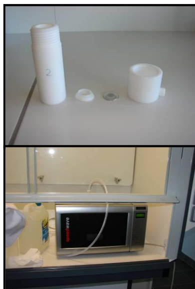
Photo 3 & 4- Bombes en Téflon (a) utilisées pour la minéralisation en four micro-ondes (b).
