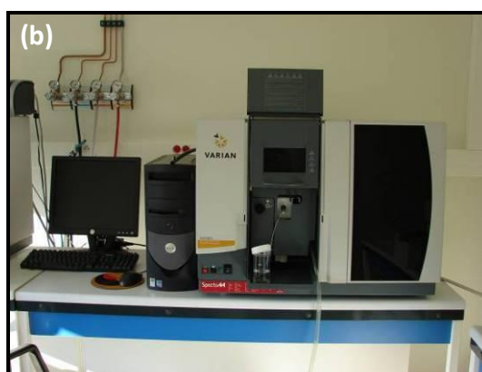
Photo 5 & 6- Spectromètres d'absorption atomique en mode électrothermique 240Z (a) et en mode flamme 240FS (b).
