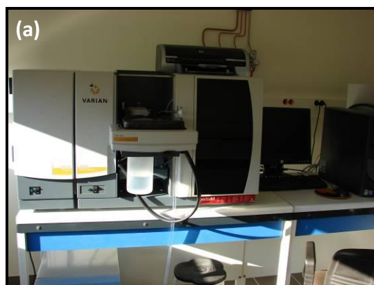
Photo 5 & 6- Spectromètres d'absorption atomique en mode électrothermique 240Z (a) et en mode flamme 240FS (b).
