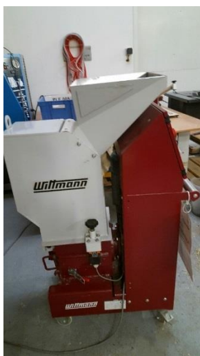
Figure 61: Broyeur à lames (grille 4 mm) et microniseur (grille 1 mm) (Source : Natureplast)
