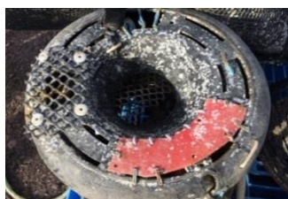
Cloche réparée de casier à bulot (Source : IVAMER)
