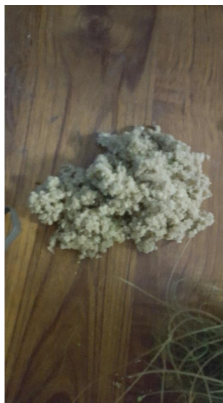
Figure 64: Photo de la cordelette brute et passée au broyeur (impossibilité pour les peluches de passer à travers la grille du broyeur) (Source : Natureplast)
