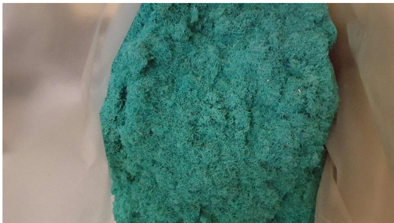
Figure 62: Filet de chalut broyé (Source : Natureplast)
