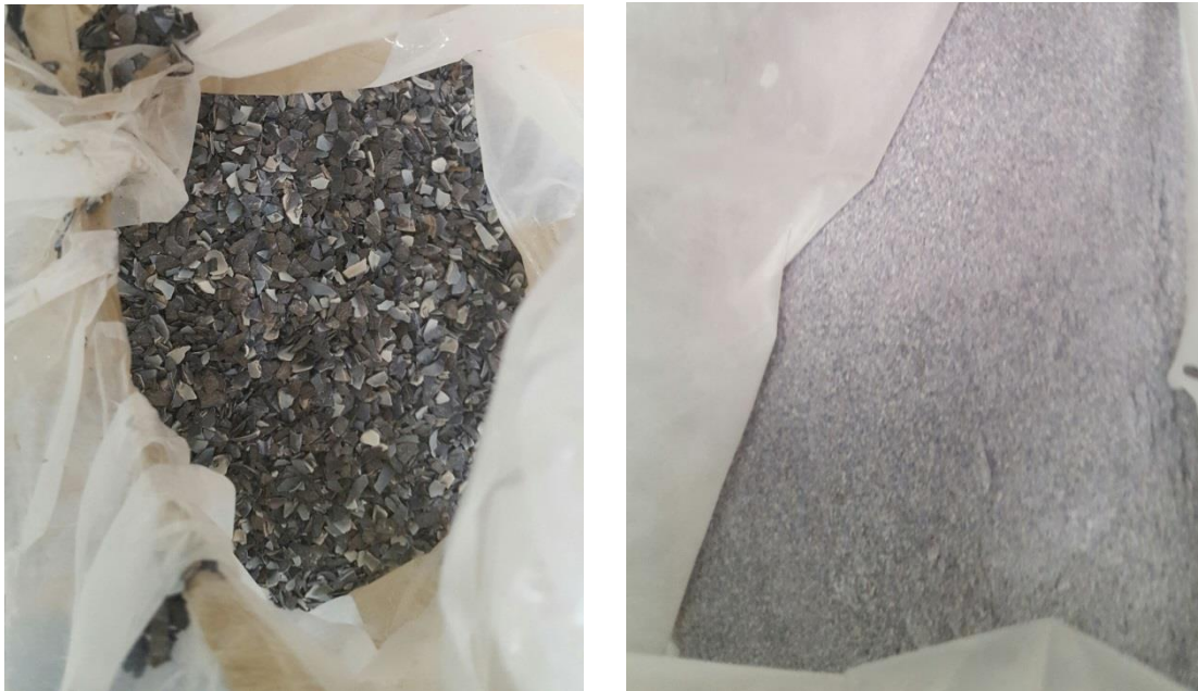
Figure 70: Coquilles de moule broyées et micronisées (Source : Natureplast)
