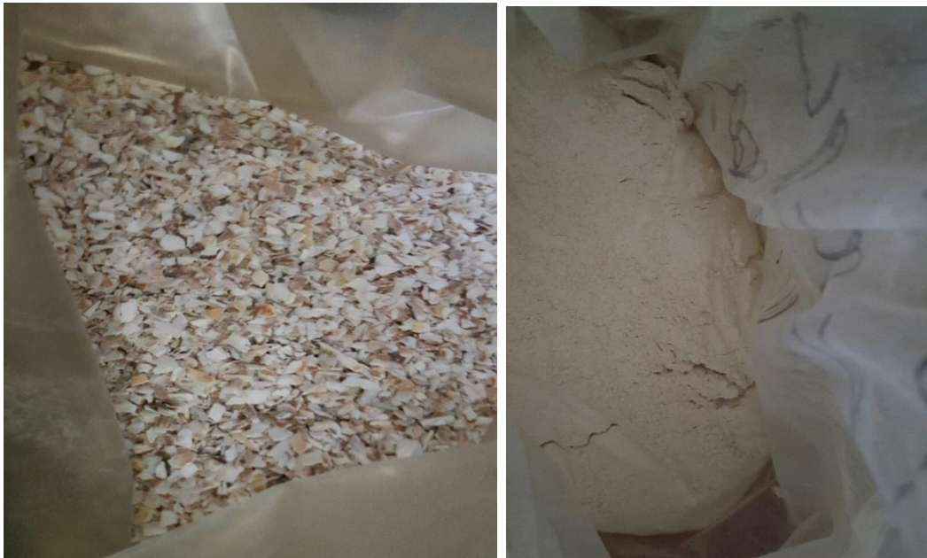
Figure 68: Coquilles Saint Jacques broyées (à gauche) et micronisées (à droite) (Source : Natureplast)
