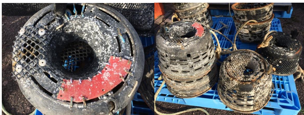
Figure 33: Casiers à bulot usagers présentant des réparations (Source: IVAMER)
