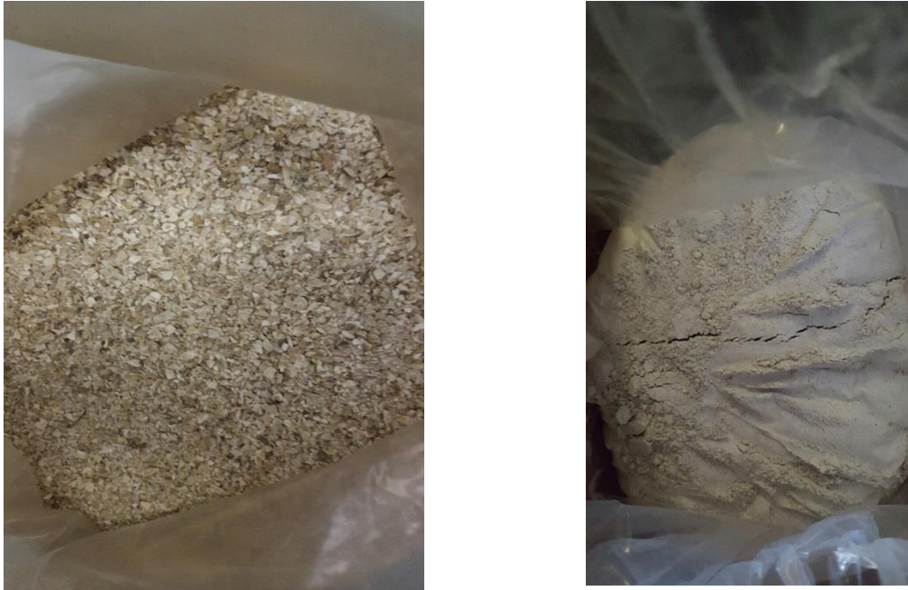
Figure 69: Coquilles d'huîtres broyées (à gauche) et micronisées (à droite) (Source : Natureplast)
