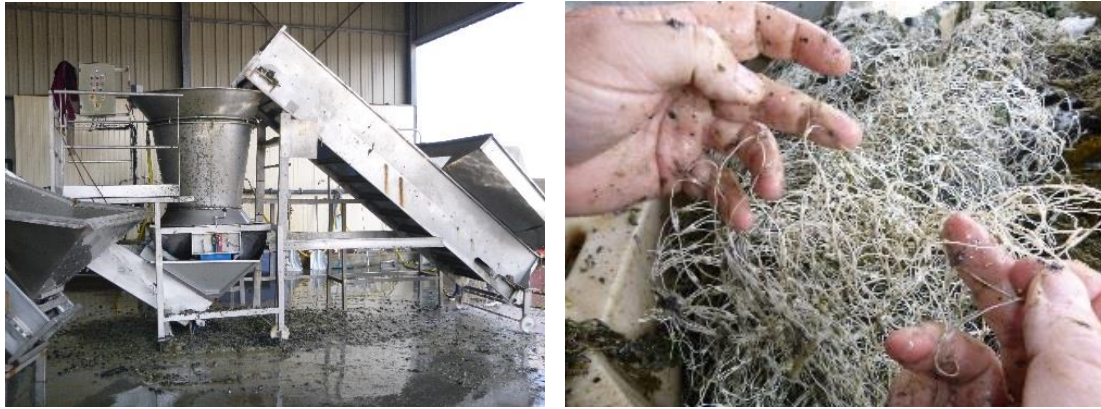
Figure 54: Dégrappeuse conique et déchet de filet après dégrappeuse. (Source : SMEL)
