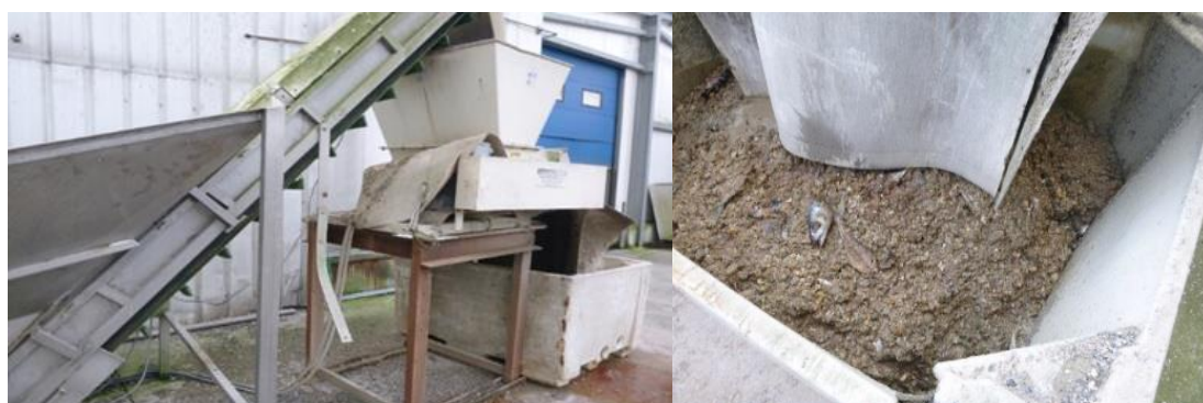
Figure 9: Broyeurs pour sous-produits coquilliers (à gauche), broyat obtenu (à droite) (Source: SMEL)
