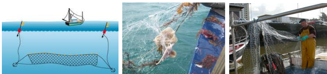
Schéma d'un filet droit (à gauche), Filet droit à rouget barbet (au centre), Filet trémil à raie (à droite) (Source : SMEL)
