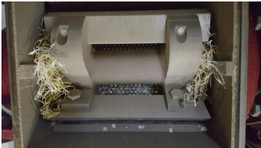
Figure 67: Enroulement des filets autour des lames du rotor (Source : Natureplast)
