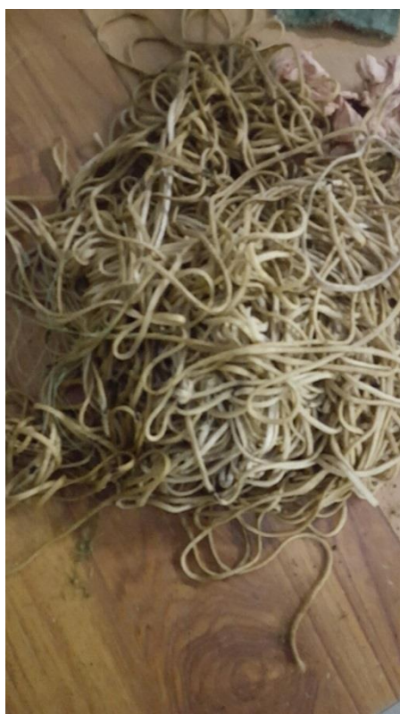
Figure 64: Photo de la cordelette brute et passée au broyeur (impossibilité pour les peluches de passer à travers la grille du broyeur) (Source : Natureplast)
