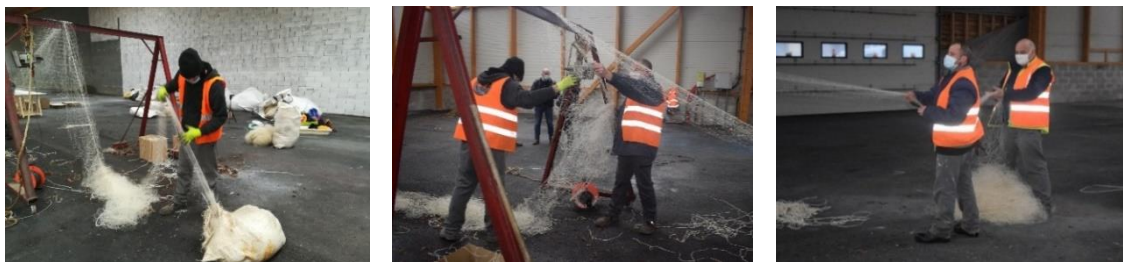
Démontage des filets fins : enlèvement de la drisse en PA et mise en pelote du filet – Source : SMEL
