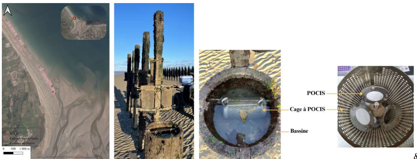
Figure 14 - Installation des POCIS au point CarUtah au Nord-Ouest de la baie des Veys
