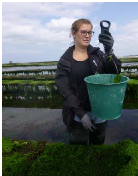
Figure 8 : Méthode de pesée des entéromorphes sur le terrain à l'aide d'un seau et d'un peson.
