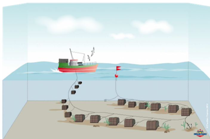
Figure 8 : Schéma d'un bulotier avec des casiers gréés en filière, posés sur le fond.
